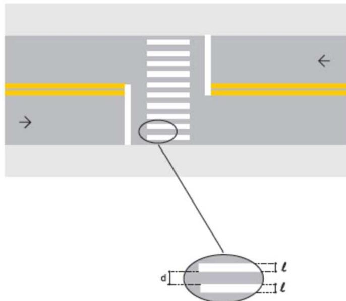
**Definição:** A FTP delimita a área destinada a travessia de pedestres e regulamenta a prioridade de passagem dos mesmos em relação aos veículos, nos casos previstos pelo CTB. A FTP compreende dois tipos, conforme a Resolução no 160/04 do CONTRAN:
