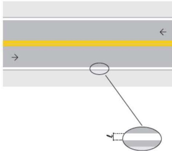
**Definição:** A LBO delimita, através de linha contínua a parte da pista destinada ao deslocamento dos veículos, estabelecendo seus limites laterais.
