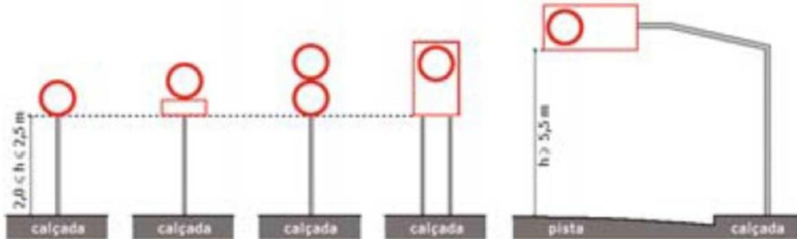
O afastamento lateral das placas, medido entre a borda lateral da mesma e da pista, deve ser, no mínimo, de 0,30 metros para trechos retos da via, e 0,40 metros nos trechos em curva.
